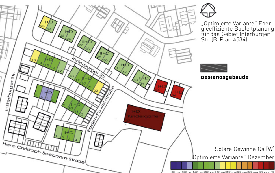
Situation der solaren Gewinne für den „Ist-Zustand“ (oben) und die deutlich verbesserten solaren Gewinne für den optimierten Zustand (unten)
